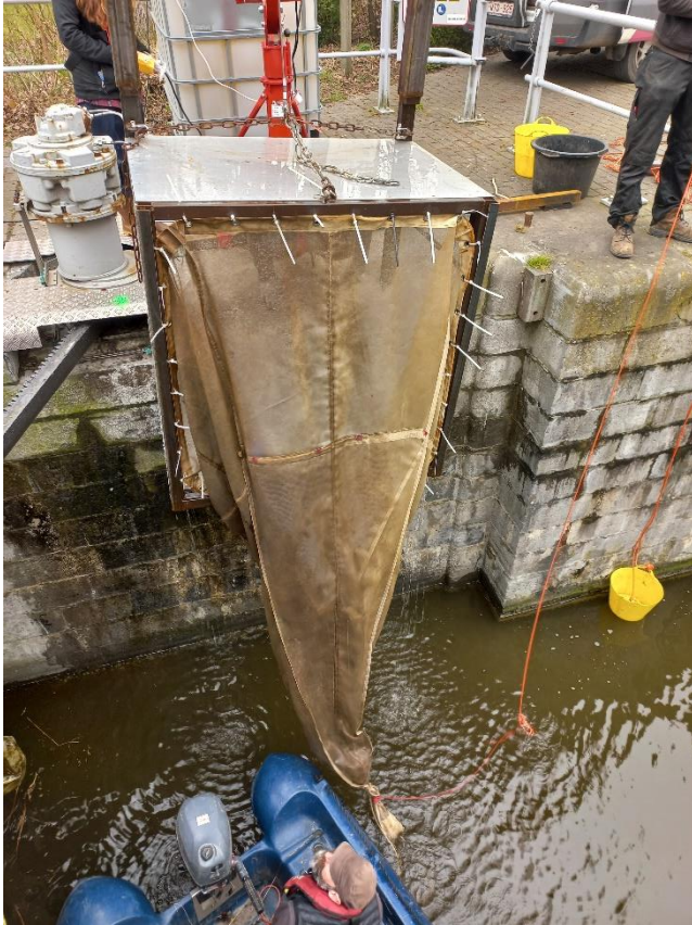
Figuur 3. Het frame met de fuij wordt via een kraan voor de opening van de stroomopwaartse vulriool op rechteroever geplaatst.
