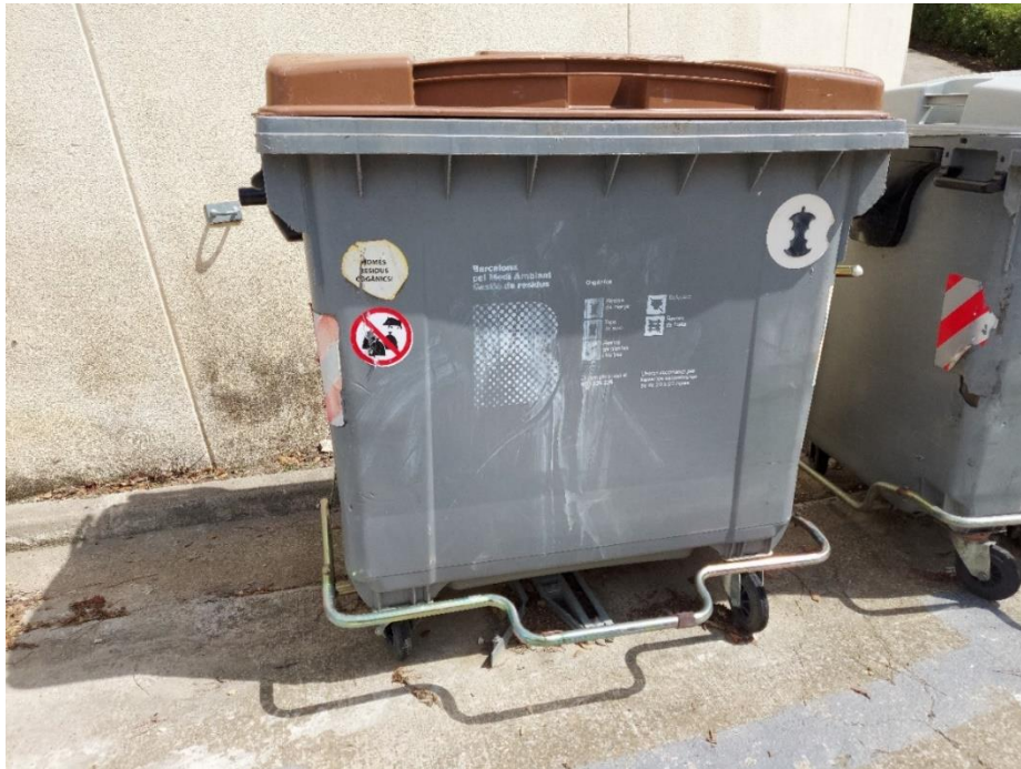
Figuur 14: Verzamelcontainer voor afval – de metalen bar onderaan moet ingeduwd worden om het deksel te kunnen openen. Hierdoor is het vuilnis niet bereikbaar voor everzwijnen (©Jim Casaer)
