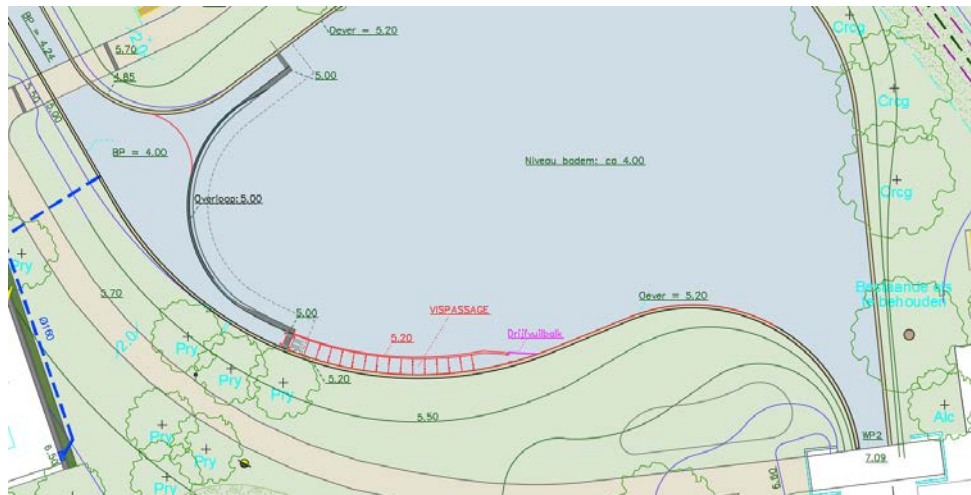
Figuur 12: Ruimtelijke inpassing van de door het INBO en WL voorgestelde vispassage op de voorkeurslocatie.
