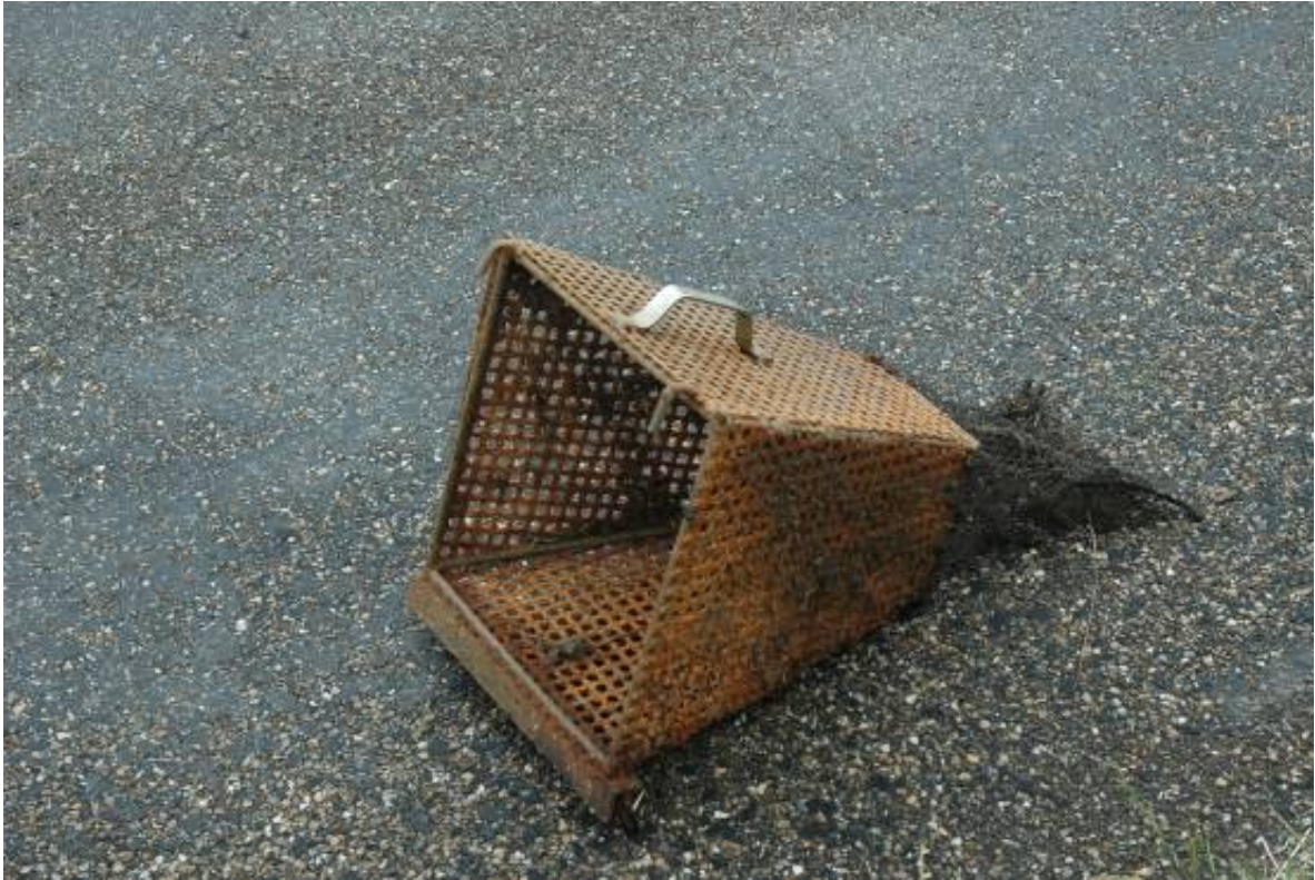
Figuur 7: Een trechter met sok wordt in een uitsparing van de roosters gehangen om stroomafwaartse migratie mogelijk te maken.
