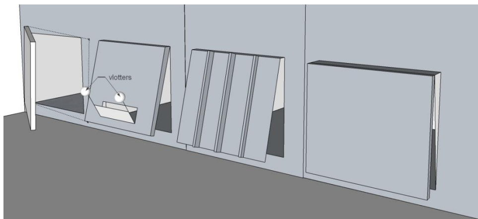
Figuur 4: alternatieven voor de terugslagklep van de gravitaire uitwateringsconstructie van de Vliet. (v.l.n.r.) Schuin opgehangen, zijwaarts scharnierende klep; klep met onderaan scharnierend kattenluik en vlotters; klep uit lichter materiaal; klep tegen schuin geplaatst afdichtvlak (standaardpositie = open).
