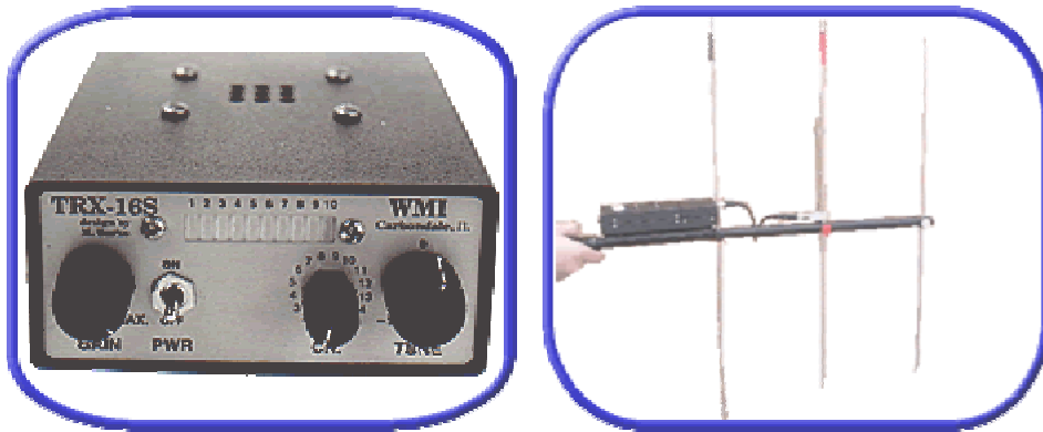
Figuur 45. TRX-16 kanalen radiosignaal ontvanger en een 3 delige Yagi antenne.
