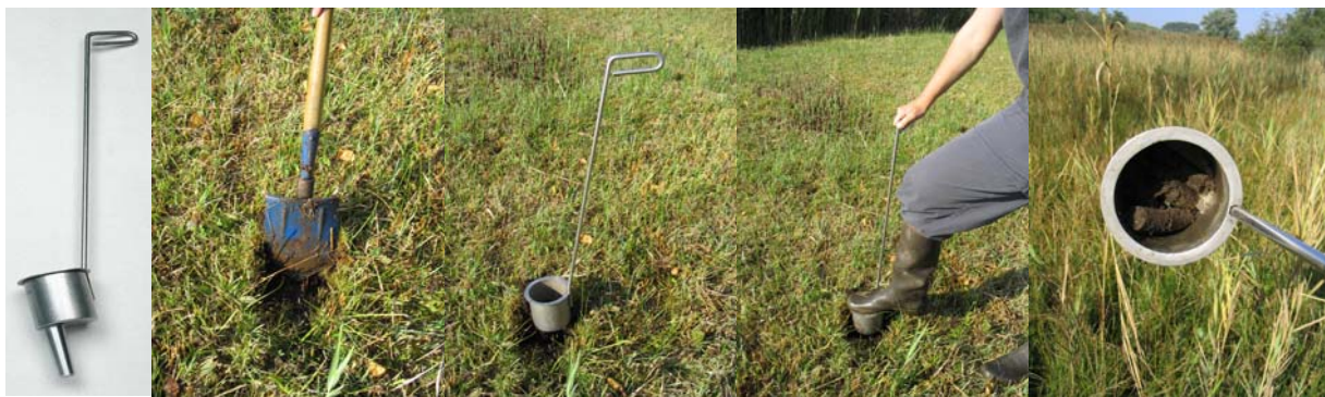
Figuur 4.5: Het nemen van bodemstalen met de “bodemprikker”.
