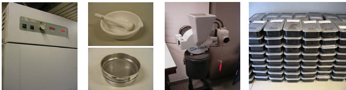
Figuur 4.6: verwerking van de bodemstalen in het labo (drogen, zeven, malen, bewaren).
