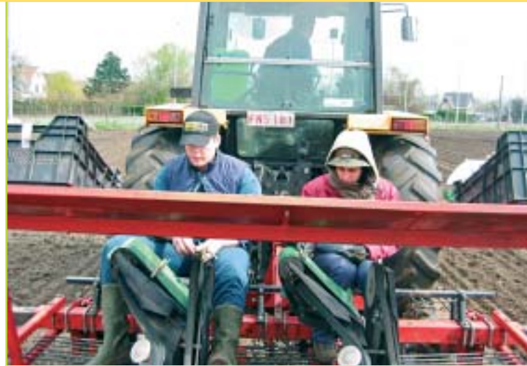
De preiplanter is voorzien van een lopende-bandsysteem, waarop de stekken worden gelegd, die dan automatisch in de grond worden geduwd.
