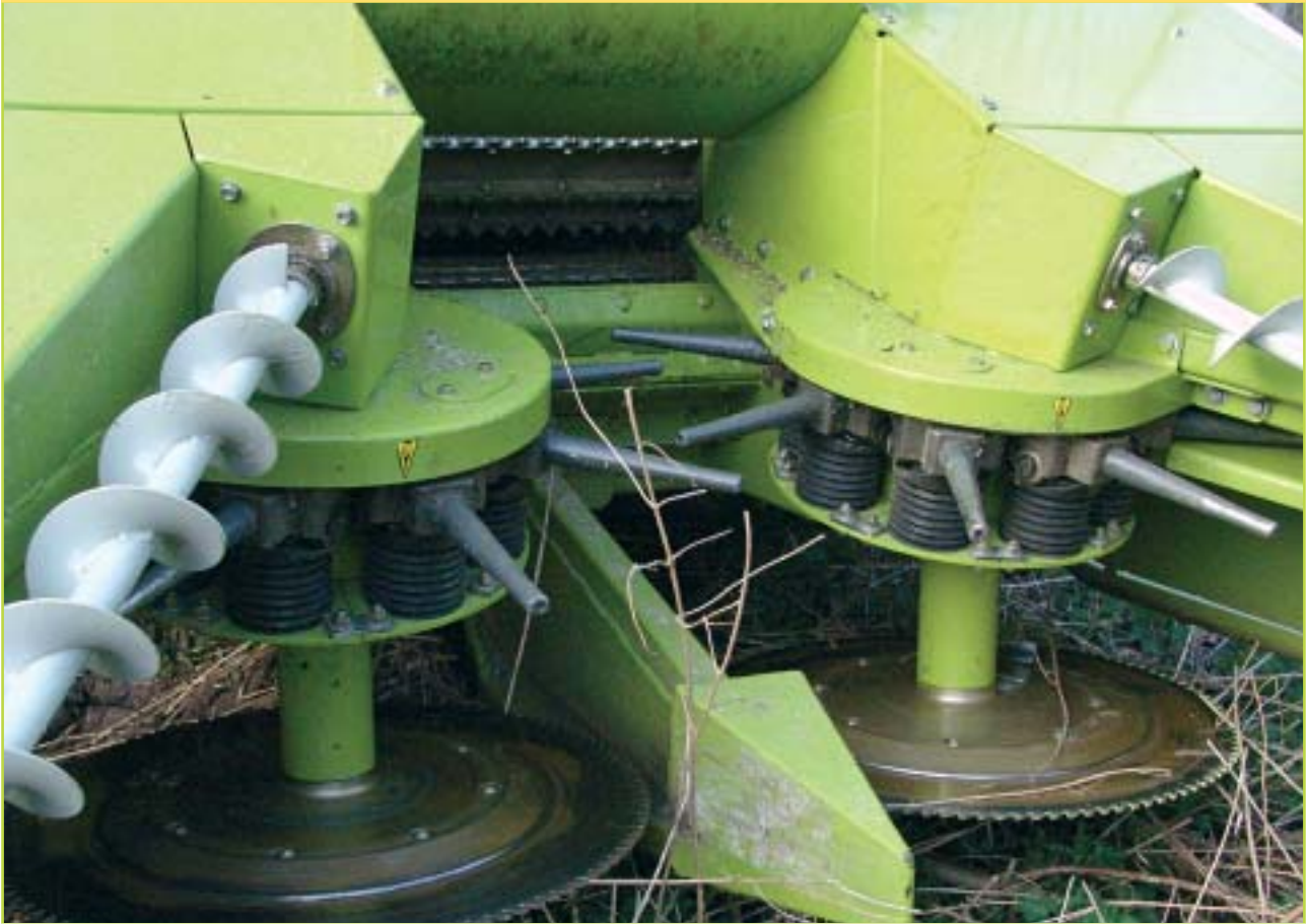
Het voorzetstuk van de KOH-verhakselaar, met de twee zaagbladen, de schuin geplaatste aanvoerschroeven en de horizontale getande rotoren, die de afgezaagde stengels naar de machinemonde geleiden.
