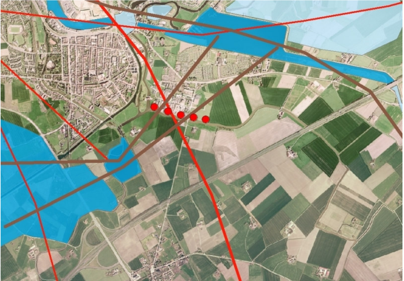
Figuur 1. Geplande windturbines (rode punten) met aanduiding van pleister- en rustgebieden (lichtblauw tot donkerblauw), niet-dagelijkse voedseltrek (bruine lijnen) en slaaptrek (rode lijnen), weergegeven in de beleidsondersteunende vogelatlas.
