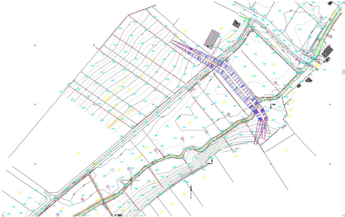
Figuur 1: ontwerpplan stroomopwaarts alternatief, met drie verschillende dijkhoogten
