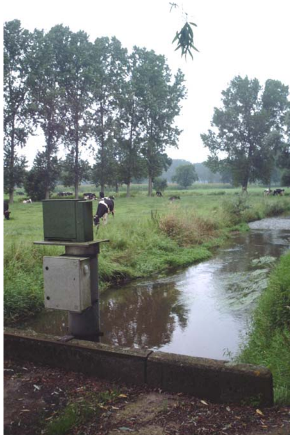
Figuur 5: foto van de meetplaats. Bemerk de plantengroei (foto augustus 2002). De golven in het water geven een indicatie van de plaats waar zich een verval (overlaat) bevindt.
