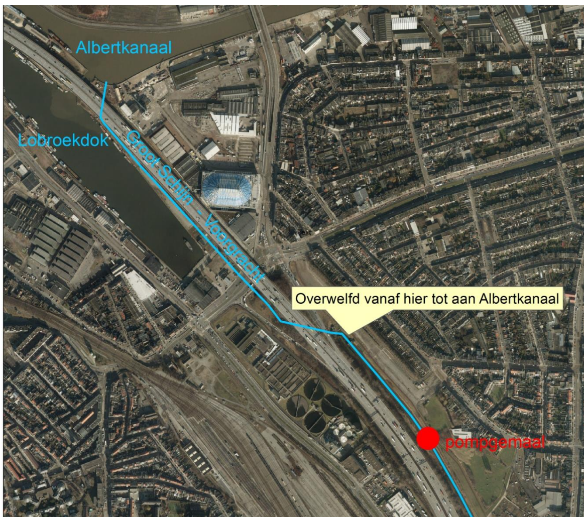
Figuur 1: Situering van het geplande pompemaal
