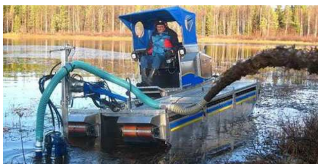
Figuur 6: Truxor uitgerust met modderpomp. In het Torfbroek is het wegsprengen van de modder op de oevers van de vijver (zoals op de foto) geen optie.
