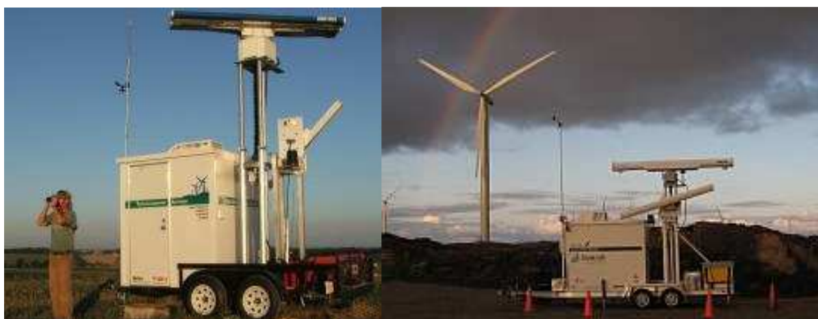
Figuur 1. Merlin radaropstelling aan bestaande en geplande windparken, met zowel een horizontaal als verticaal opgestelde radar (Detect 2007).
