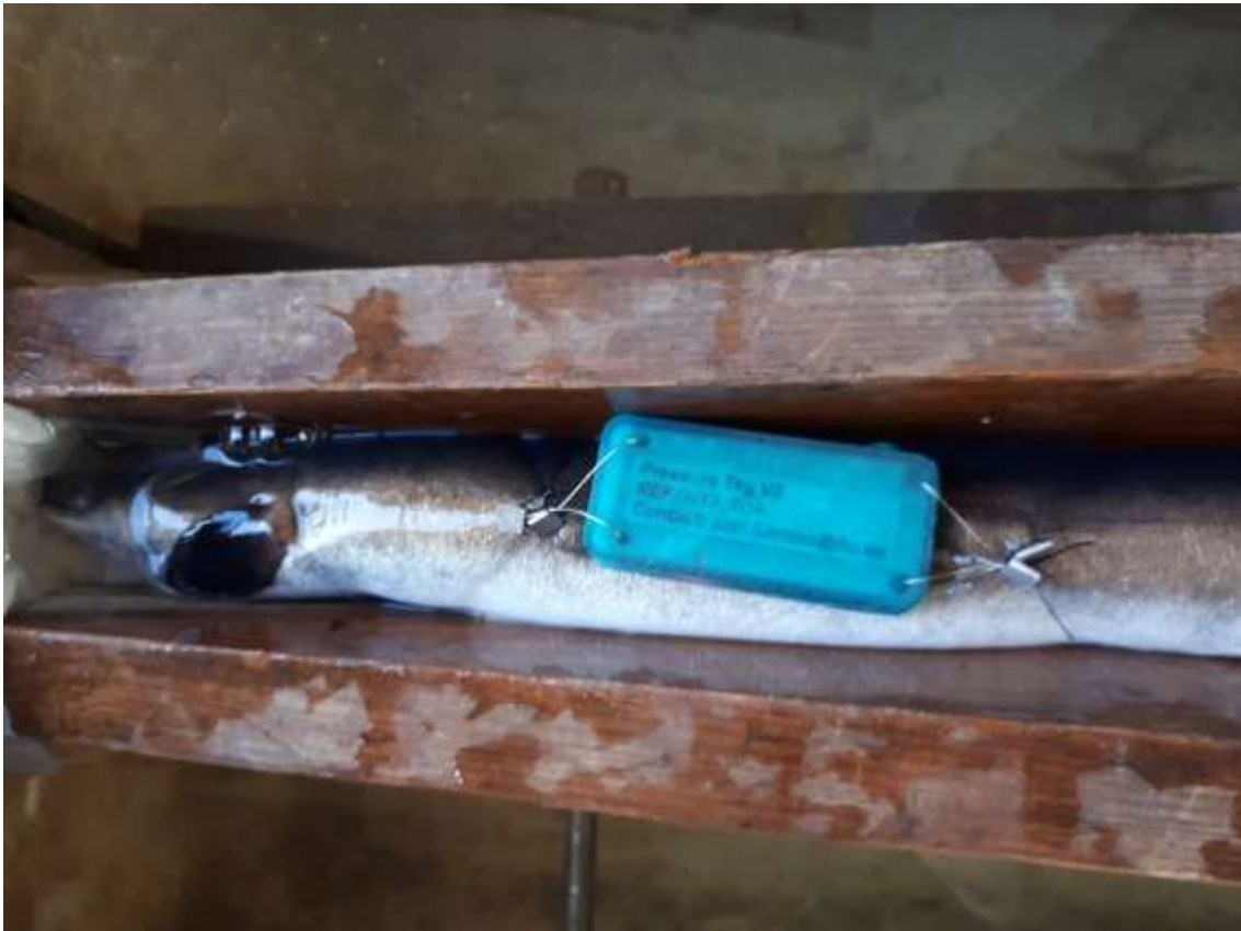
Figuur 22. Sensor bevestigd op de flank van een verdoofde paling.
