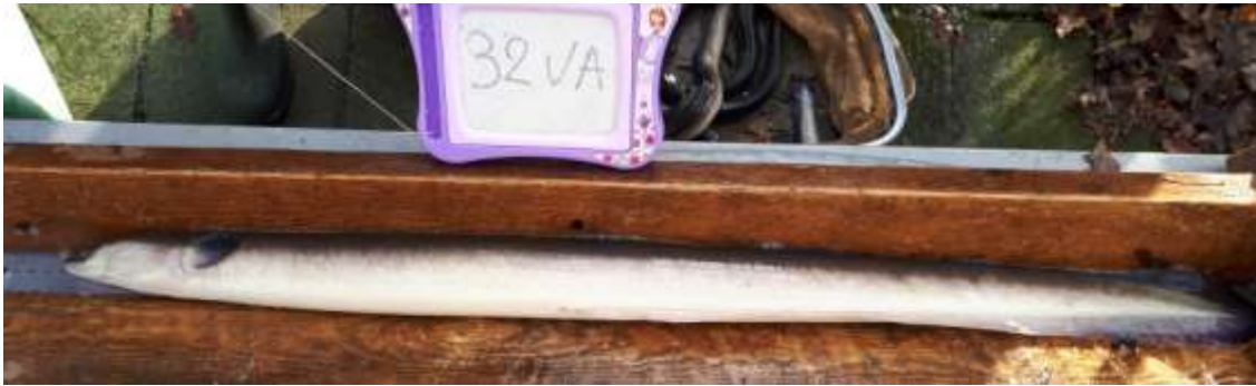
Figuur 14 Ongeschonden palingvrouwtje in goede conditie na een doorvoervoerproef bij 550 rpm.
