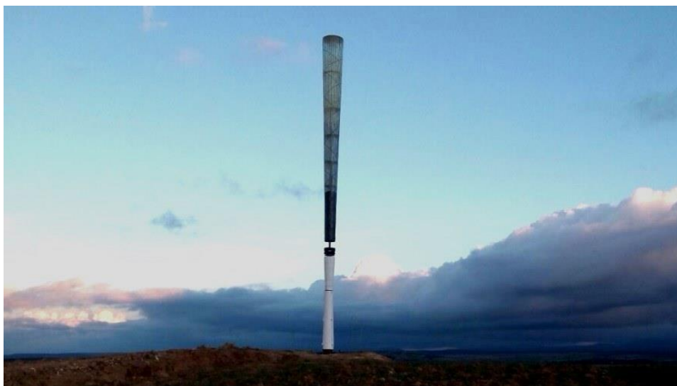
Figuur 2. Nieuw type windturbine zonder wieken op basis van vortex technologie.
