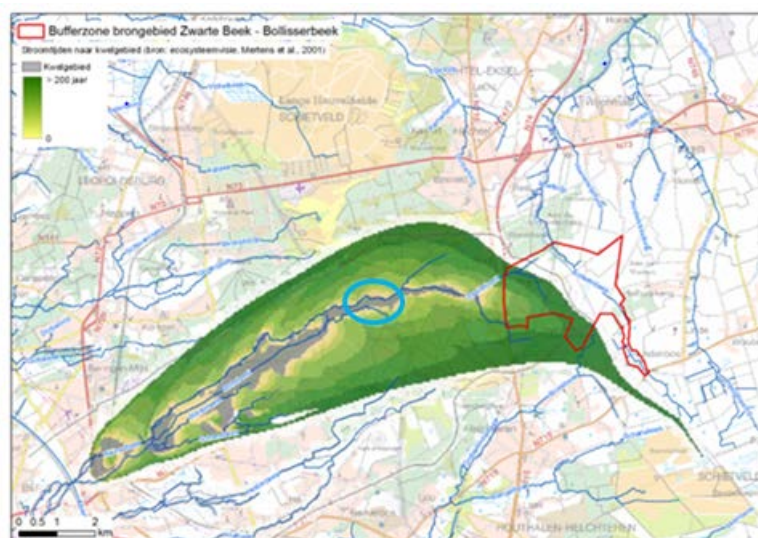
Figuur 3: Infiltratiegebied en verblijftijd van grondwater in de Zwarte Beek (Vandaele et al. 2001) met blauw omcirkelde aanduiding van de zone waar het in dit advies over gaat
