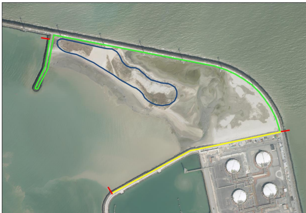
Figuur 1. Overzichtskaartje Sternenschiereiland, met in het geel de draad langs de LNG-dam (2009) met aan beide uiteinden een zeewaartse 'dwarse barrière' (rood), in het groen de elektrische bedrading langs de binnenzijde van de oostdam (2013) met op het uiteinde de bijkomende 'dwarse barrière' (rood), en in het blauw ten slotte een conceptvoorstel van een eventueel nieuw te plaatsen afrastering.
