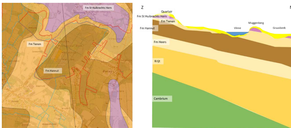
Figuur 3: Datzomende tertiair geologische lagen (links) met aanduiding van de ligging van het dwarstransect (rechts) voor Het Vinne
