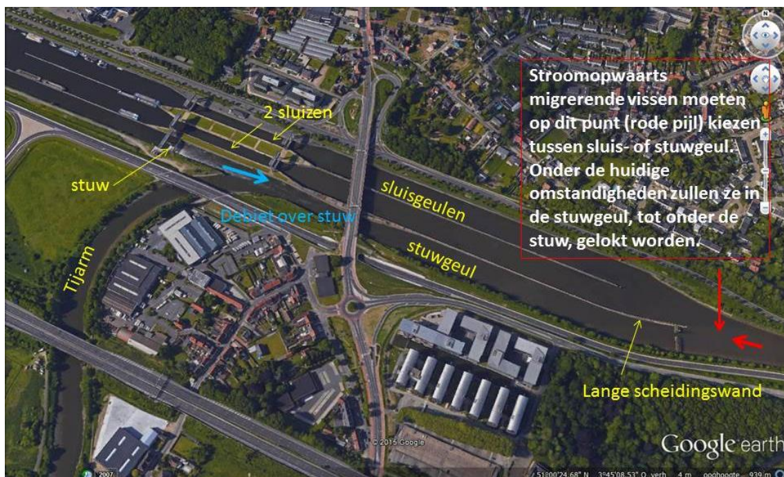
Figuur 6. Luchtfoto met aanduiding van kunstwerken, stuwgeul, beide sluisgeulen en de Tijarm
