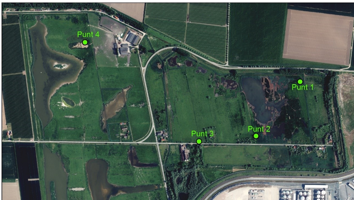
Figuur 7: locatie van de piëzometers voor het meten van kweldruk.
