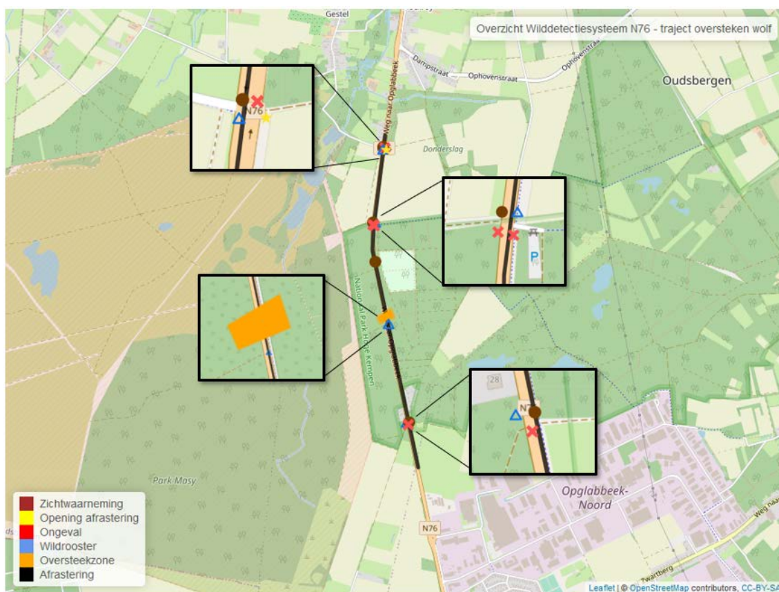
Figuur 2: Overzicht van het wilddetectiesysteem op de N76 en zichtwaarnemingen (bruine bol) en ongevallen (rood kruis) met wolven na plaatsing van het systeem (Zie https://inbo.github.io/fis-reports/ voor een interactieve kaart). (zwarte lijn = raster, oranje rechthoek = oversteekzone, blauwe driehoek = wildrooster, gele ster = opening tussen een wildrooster en het raster)
