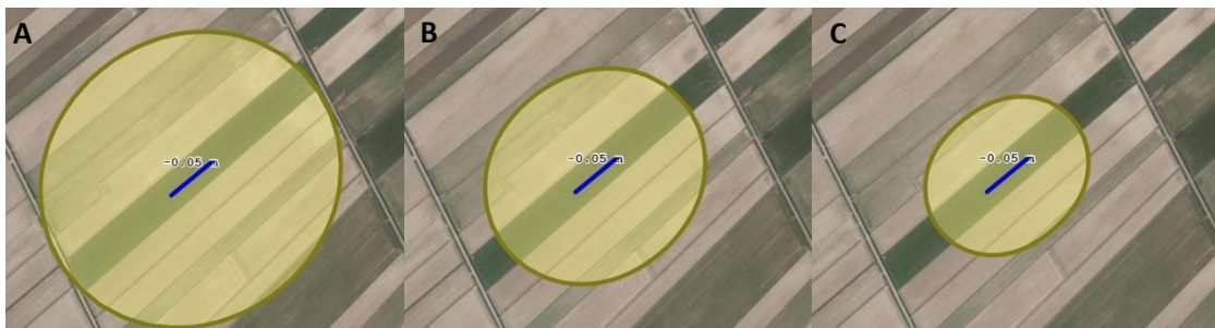
Figuur 3.1: 5 cm contour bij lijnbemaling in huidige voortoets. A = 5 putten, B = 10 putten, C = 20 putten (maximum aantal). De gewenste verlaging en het maximum debiet van de bemaling is voor alle drie gevallen hetzelfde.
