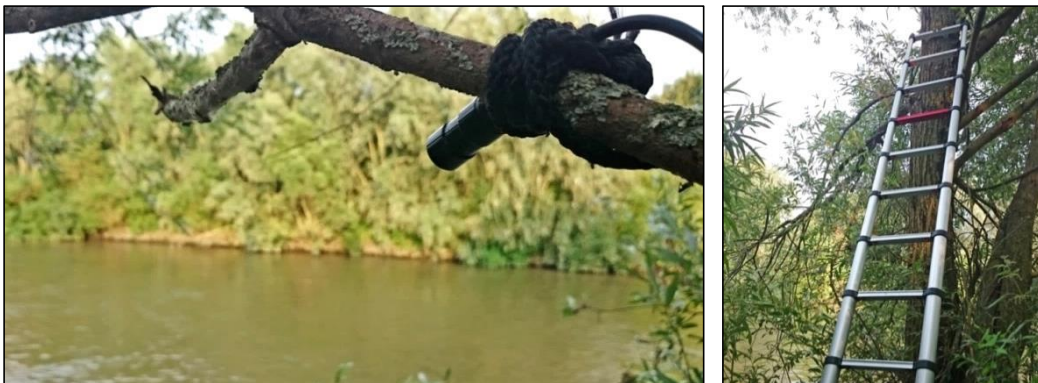
Foto 14. Een automatische batdetector met externe microfoon langs de Leie en de installatie ervan.
