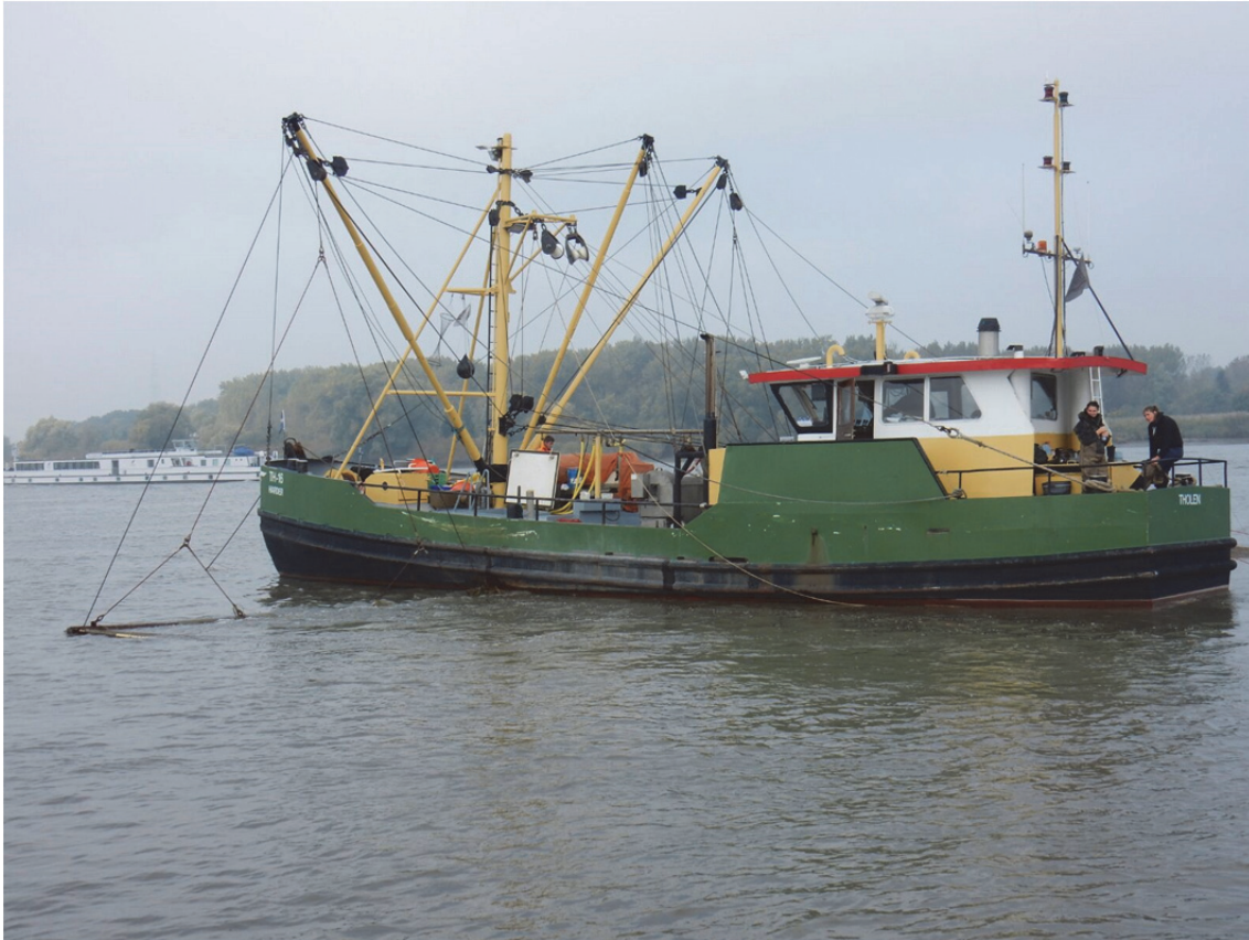
Figuur 3. De Harder aan het kuilen (Foto: Jan Soors).
