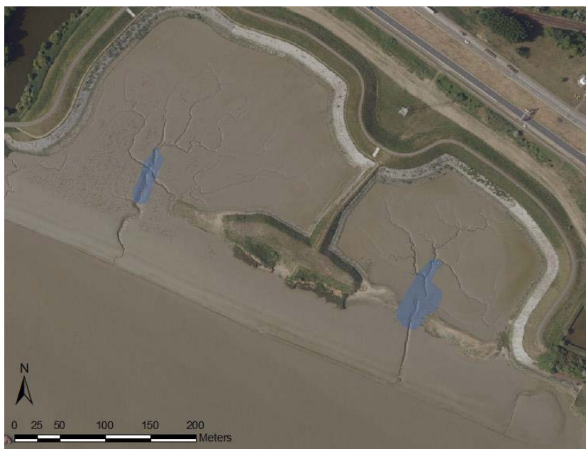
Figuur 6: Estuarien herstel in Potpolder Lillo: situatie 2015 met in blauw de in 2012 uitgegraven bressen en overdieptes.
