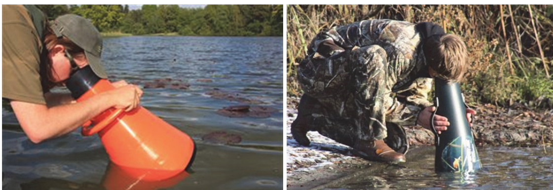
Figuur 78 Onderwaterkijker (foto links: waterplanten.info, foto rechts: thecarpspecialist.nl).
