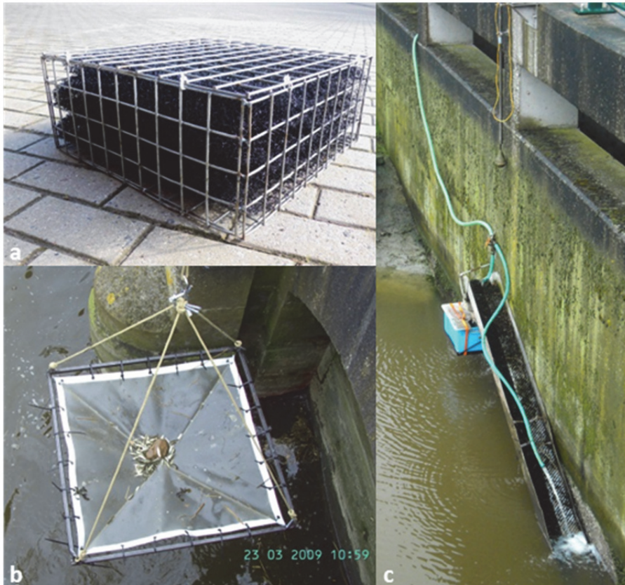
Figuur 4 Overzicht van de diverse vangstconstructies die in het Afvoerkanaal werden toegepast om de glasaalmigratie te kwantificeren. a. artificieel substraat ('flottang'), b. kruisnet en c. palinggoot.
