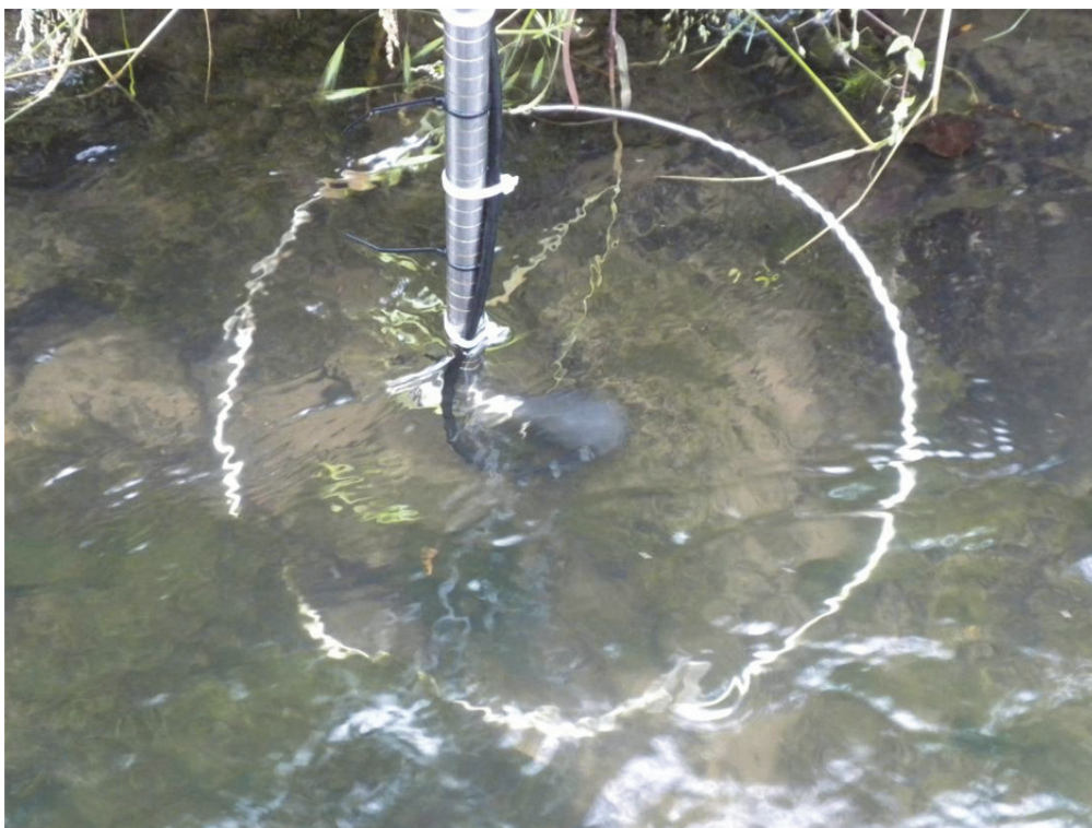
Figuur 58 Metalen ring met diameter van 40 cm waarbinnen in elk meetpunt de stroomsnelheid, waterdiepte en ingebedheid van het substraat worden ingeschat.
