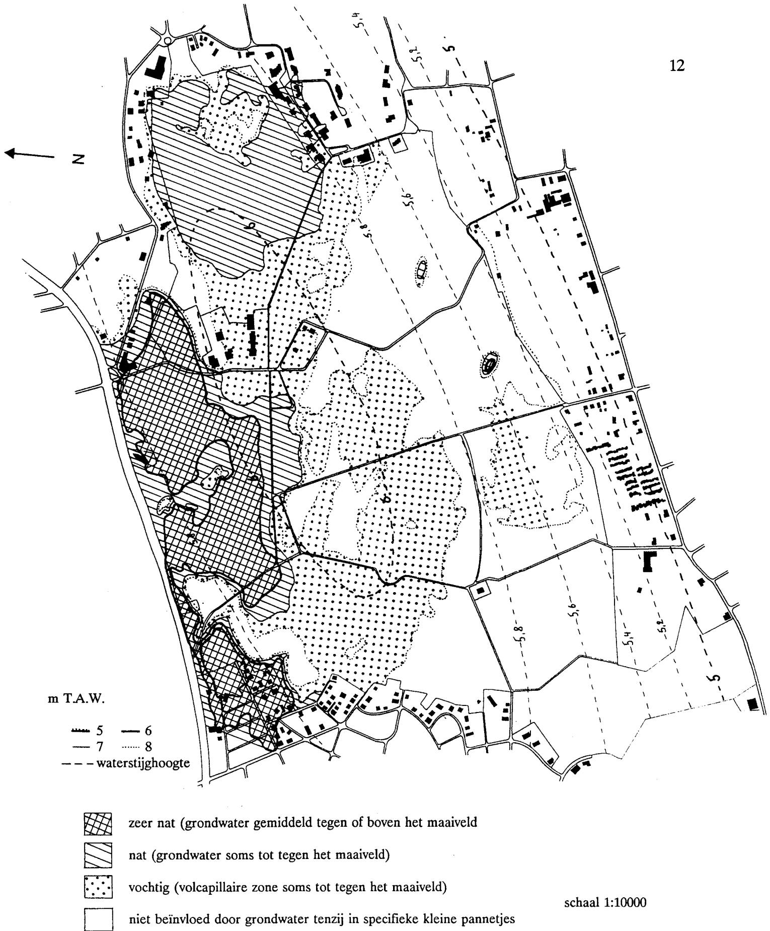
Figuur 1.7. Stijghoogtelijnen in de bovenste zandlagen van de Doornpanne in natuurlijke omstandigheden. Potentiële vochtigheidstoestand van de bodem (IWVA 1993).
